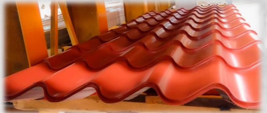
La lámina Acanalada Galvateja se fabrica a partir de acero galvanizado pintado calibre 26, el cual pasa por un proceso de pintado, acanalado y troquelado que le proporciona una apariencia de teja tradicional, pero con la resistencia y durabilidad del acero.
